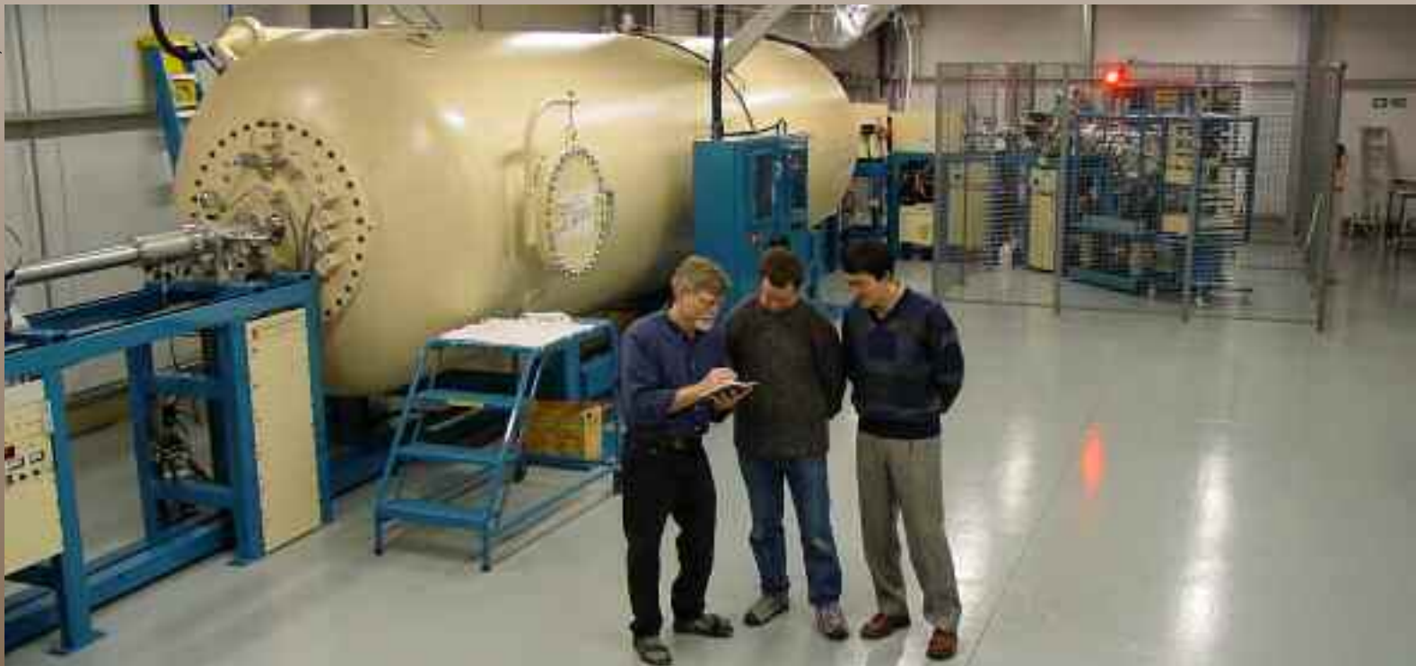
Sbectromedr Mäs gyda Chyflymydd yn labordy dyddio radio carbon SUERC. Mae popeth byw yn cynnwys ychydig bach o garbon ymbelydrol (C 14 ). Gan ei fod yn pydru'n raddol a chyson, gellir dyddio sampl ar sail faint o C 14 sydd ynddo. Mae'n bosibl mesur C 14 gyda Sbectromedr Mäs gyda Chyflymydd. The Accelerator Mass Spectrometer at the SUERC radiocarbon dating lab, East Kilbride. All living things contain a small amount of radioactive carbon (C 14 ). As this decays at a regular rate, the amount of C 14 in a sample can be used to date it. C 14 can be measured by an Accelerator Mass Spectrometer.
